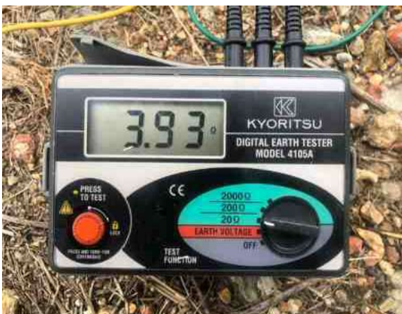
ค่าการวัดจุดต่อลงดินของกัปดักไฟฟ้า (Lightning Arrester)
